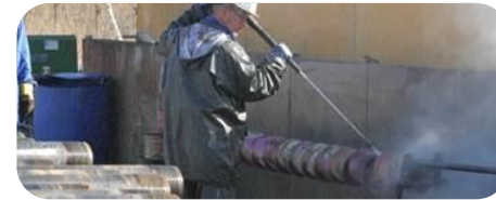
3) Dégraisser le protecteur
